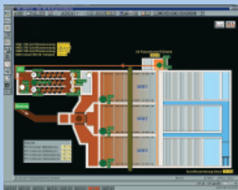
Anlagenbild Kläranlage im Leitsystem
